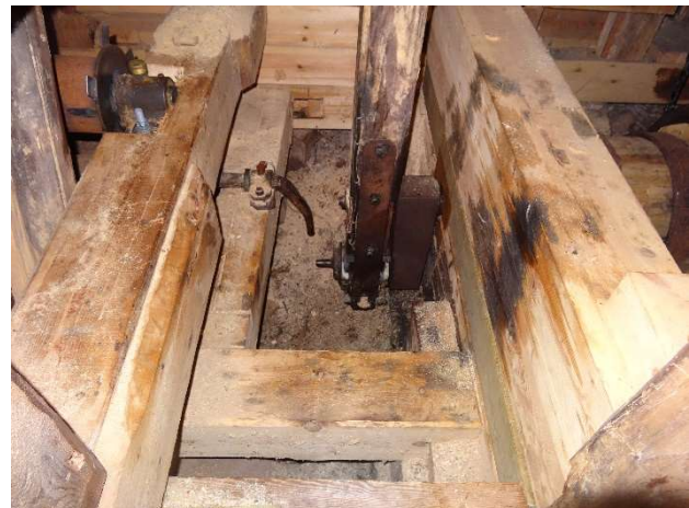
Vevslängan. Till vänster syns del av spelet, som drar in stockarna i sågen. 12 okt 2013.
