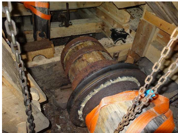
Inre axelände på plats i sitt lager. Ringen på axeln används för att spela tillbaka stockmatningen.
