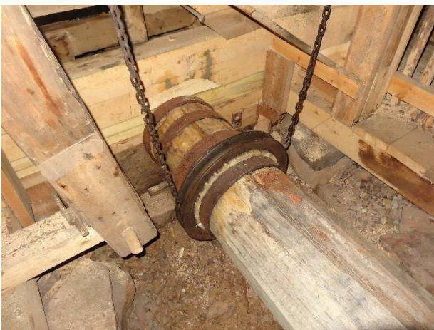
Kätting för att spela tillbaka stockmatningen. 12 okt 2013.
