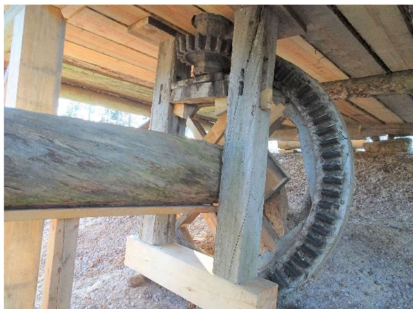
Kuggjulet på axeln och kuggjulet som för upp rotationen genom golvet.
