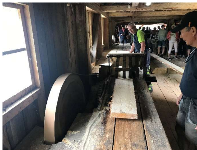
Plankorna och brädorna kantas sedan i kantverket, som har två klingor mellan vilka avståndet kan justeras till rätt bredd för respektive plankor/bräda.
