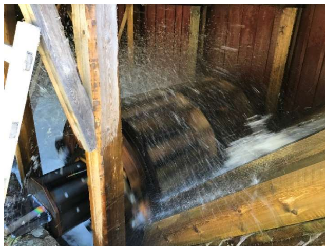
Underfallsvattenhjulet för ramsågen i drift.
