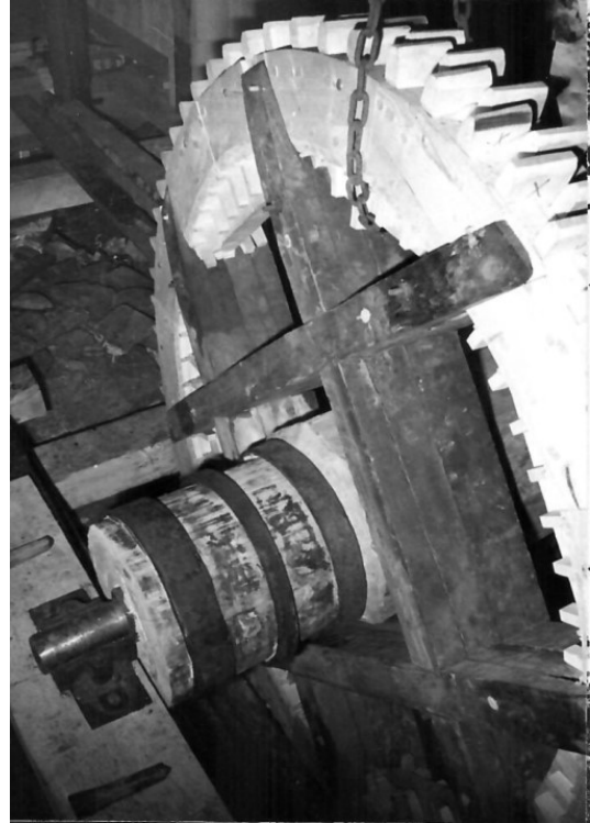
Kugghjul till kantverket under montering.
