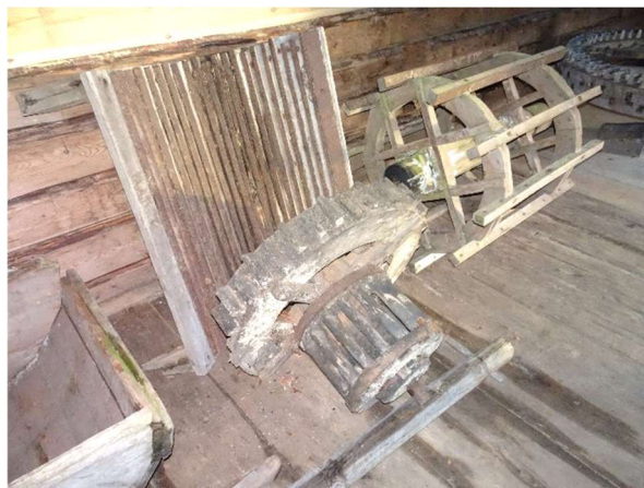
Utrustning upplagd inne i tröskladan. Det horisontella kuggjulet, som sitter på den vertikala axeln genom golvet, skymtar längst till höger i bilden.
