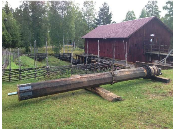
Färdig axel med yttre lagertapp till vänster och vevslängan till höger.
