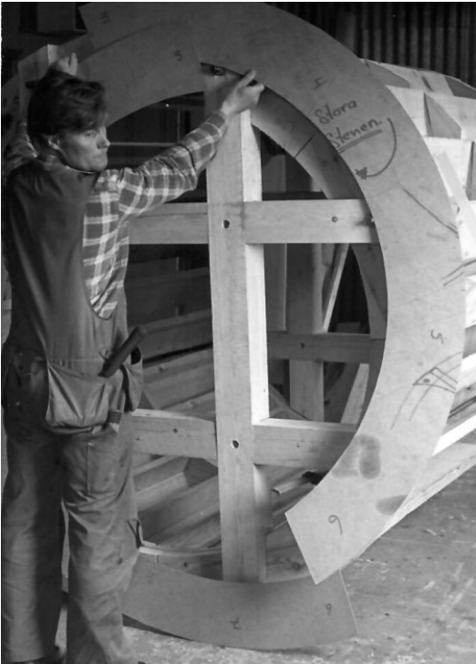
Underfallsvattenhjulet till ramsågen under tillverkning.
