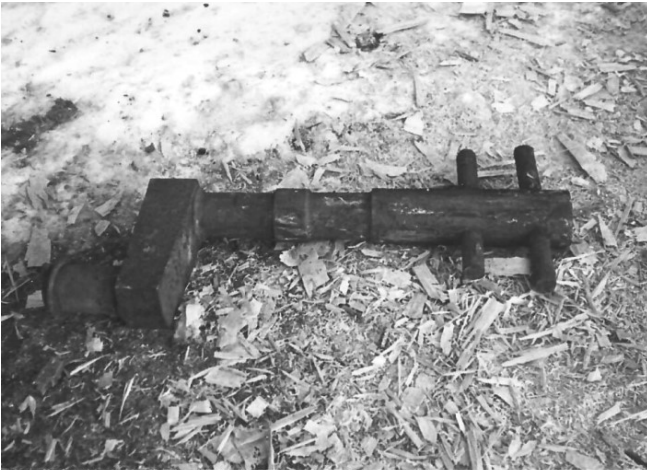
Vorrlång till vattenhjulsaxel maj 7 Län väger ca 170 kg.
