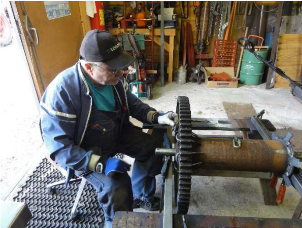
En ny axel tillverkades också för kugghjulet som drar kättingen som spelar in stockarna i sågen. 23 sep 2013.
