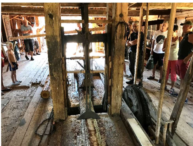
Stockarna sågas först i ramsågen som har 7 sågblad. Vi ändrar inte postningen utan sågar 2 st 2" plankor i mitten, utanför dessa 2 st 1" brädor och ytterst 2 st 3/4" brädor.
